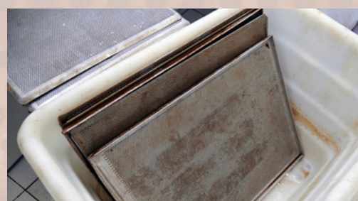
4. Po wyjęciu z wanny blachy należy odłożyć na chwilę do pojemnika lub specjalnego wózka, aby HEAM spłynął z powierzchni.
